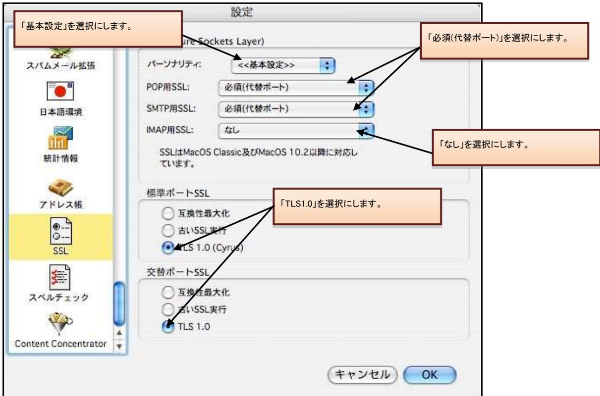
2.7. [設定] ウィンドウ内の[ポート/プロトコル] をクリックして、以下の情報に設定します。
